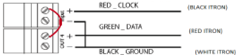
Abbildung 39: ORION Cellular LTE-Endpunktverbindung mit Widerstand
