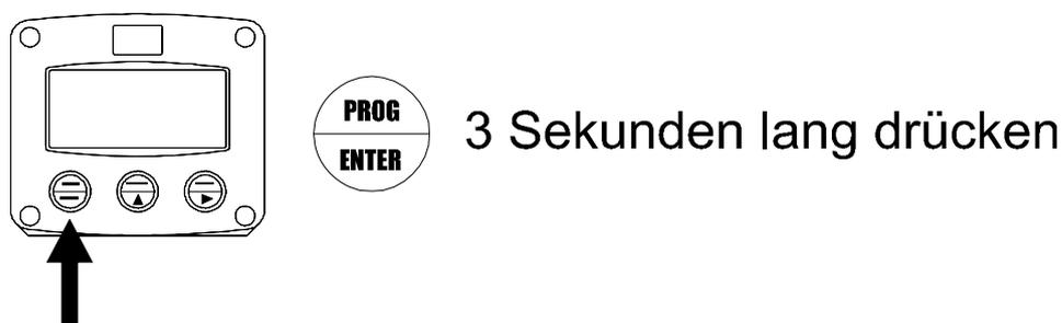
Sie kehren zur Bedienerstufe zurück, indem Sie PROG drei Sekunden lang drücken. Wenn 2 Minuten lang keinerlei Tasten gedrückt werden, wird die SETUP-Stufe automatisch verlassen.
