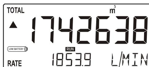
Fig. 4: Beispiel Alarm: Batterie schwach
