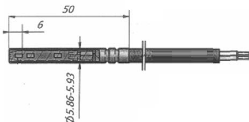
Abbildung 17: Gesamtabmessungen der Temperatursensoren vom Typ PL
